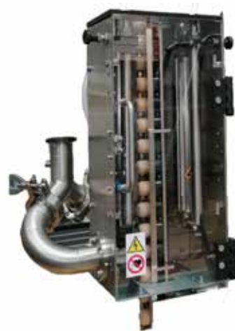
Komora odpylająca na ześlizgu zakrywek
