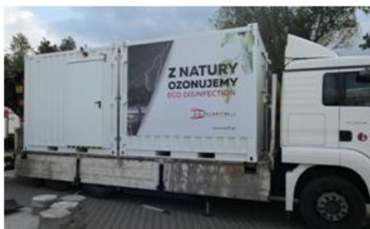
SPID Serii Red do produkcji wody wysoko-ozonowanej 4 m 3 /h
